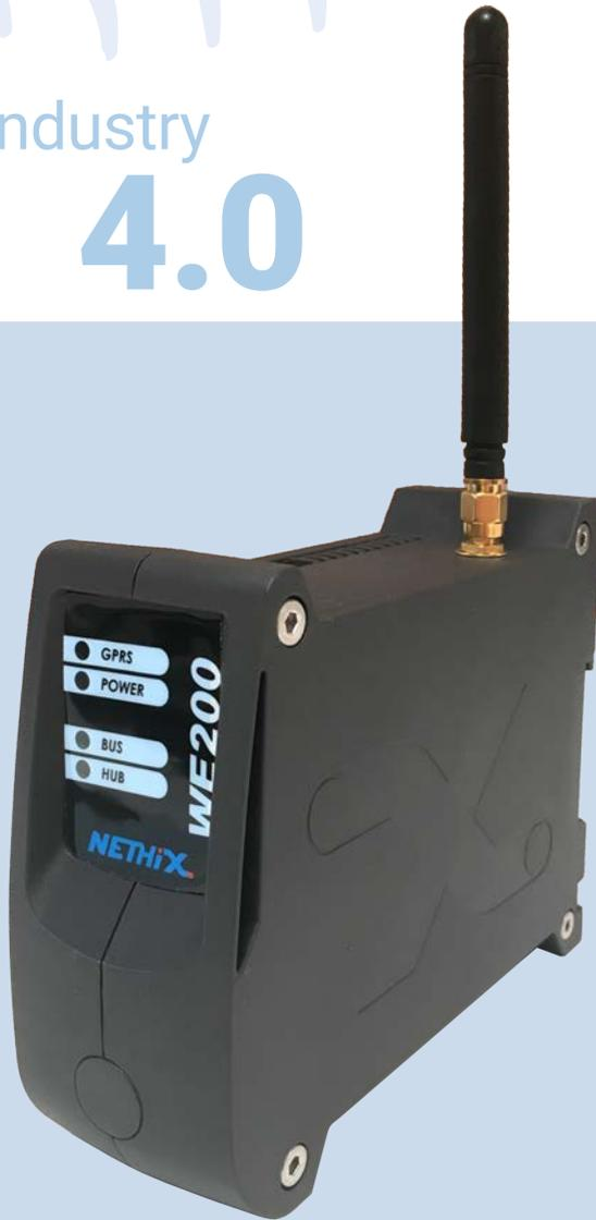
**WE200** ist ein zuverlässiges, effizientes und hochleistungsfähiges industrielles Gateway, das die Fernwartung jeder Maschinen oder Anlagen über Ethernet, USB oder serielle Schnittstelle erlaubt.
