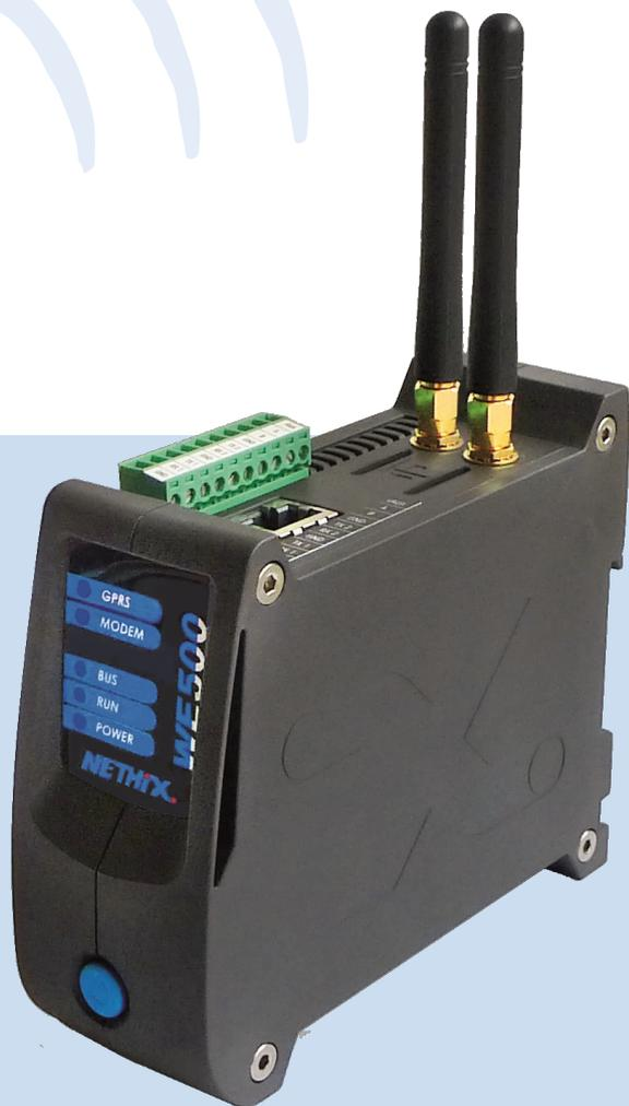
**WE500** Dual Modem è una soluzione flessibile, autonoma e ridondante che garantisce elevate prestazioni in tutte le applicazioni di telecontrollo wireless con connettività 2G e 3G non presidiato. E' la soluzione ideale per il monitoraggio, il controllo e la raccolta dati.
